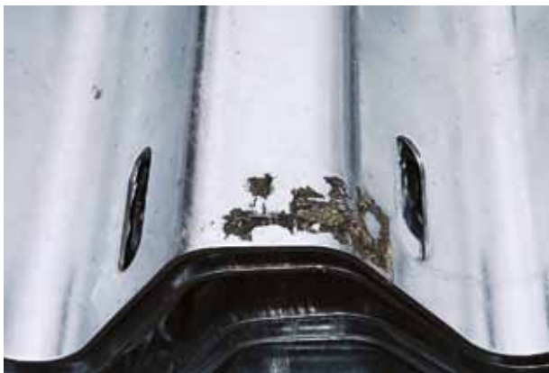
Непроцинковка из-за нанесения маркировки, самоклеющихся бирок
